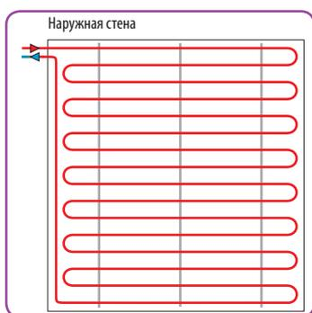
При такой раскладке, трубы, как правило, идут внутрь от наружной стены. Это обеспечивает для прилегающего к наружной стене участка самую высокую температуру поверхности пола и, следовательно, самую большую теплоотдачу. По мере движения по помещению вода охлаждается, вызывая падение температуры поверхности и, следовательно, теплоотдачи.
